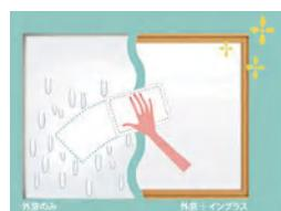
既存の窓と、内窓として取付けたインプラス、さらにその間に生まれる新しい空気層が室外と室内をしっかり隔てる構造に。大きな断熱効果で外気温の影響を受けにくくし、結露の発生を抑えます。
