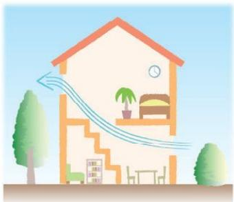
開口部を2か所以上開けて、風の入口と出口を確保。開口部の位置に高低差があると風が通りやすくなります。
